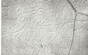
Ingranditi centofold volte dal microscopio elettronico, scopriamo in questa fotografia i segni dell'invecchiamento dell'acciaio dolce, rappresentati dalle linee più marcate convergenti in un punto, in alto a destra. Finché il metallo è giovane, le transizioni cristalline hanno la capacità di adeguarsi facilmente alle sollecitazioni esterne. Ma col tempo, si possono verificare nel tessuto metallico degli spostamenti locali di certi elementi che si raggruppano in un punto, per poi diminuire la capacità di adeguamento alle sollecitazioni. Fenomeni analoghi si verificano nell'invecchiamento dei tessuti umani.
