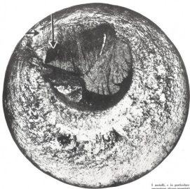
I metalli, e in particolare l'acciaio, presentano alcune proprietà e reazioni simili a quelle di un organismo vivente. Come ogni essere umano, anche l'acciaio può, ad esempio, «cattarsi». La foto riproduce la sezione di un albero di trasmissione nel punto (indicate dalle due frecce) in cui si è verificato un fenomeno di «cattarsi».
